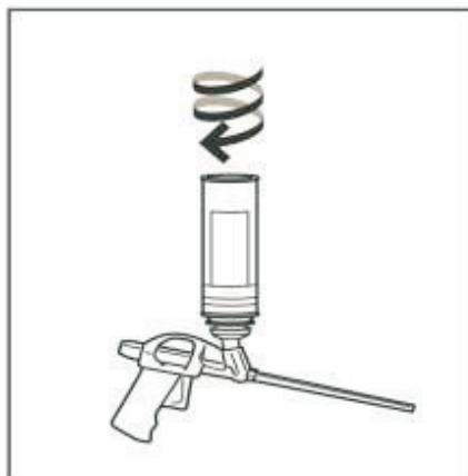
Rys. 2 Umieścić puszkę w gnieździe pistoletu i dokręcić do oporu.
